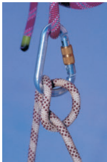
Puolisiansorkalla solmittu köysi kiertyy sulkurenkaassa tai tolpassa itsensä ympäri, joten siitä syntyy jarrukitkaa.
