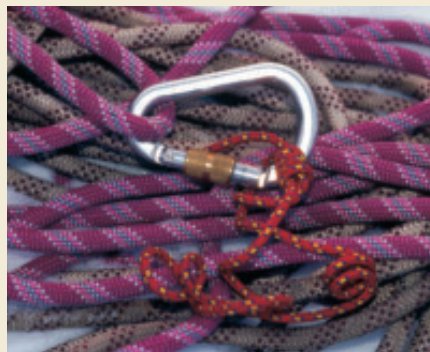
Kuvassa lila köysi on 10,5 mm dynaaminen eli joustava köysi. Valkoinen on yhtä paksu staattinen eli joustamaton köysi ja ohut punainen on prusik-apunaru.
