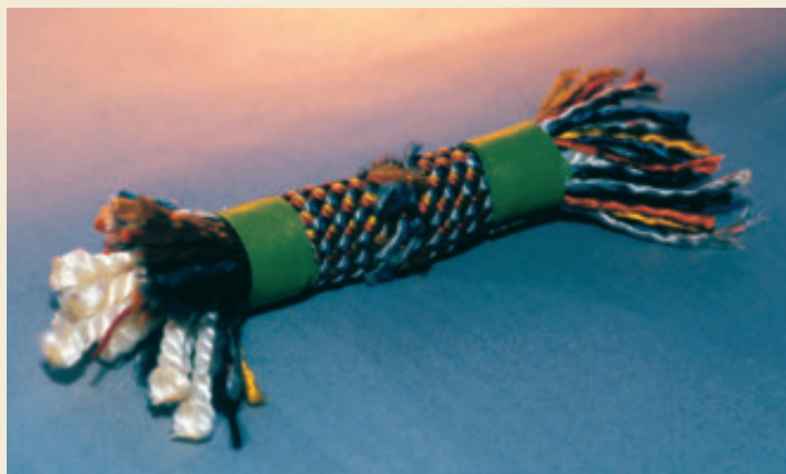
Hyvän köyden rakenteessa on sisällä useista ohuista säikeistä koostuva ydin ja päällä suojaava kuori eli mantteli. Kuvan pätkä on säästetty muistoksi jännistä hetkistä Korouoman Mammuttiputoukselta. Löin hakun läpi köydestä n. 12 metrin korkeudessa.
