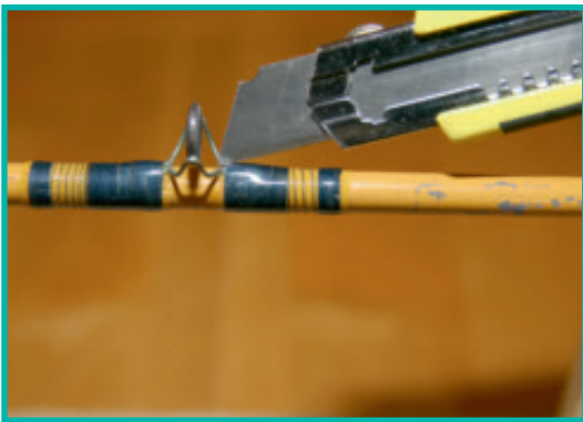
Vanhan vaparenkaan sidokset leikataan renkaan jalkaa vasten, jotta aihio ei vahingoitu.
