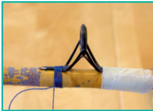
Ennen vaparenkaan sitomista se teipataan oikeaan paikkaan. Teippi irrotetaan vasta, kun renkaan toinen jalka on sidottu kunnolla kiinni.
